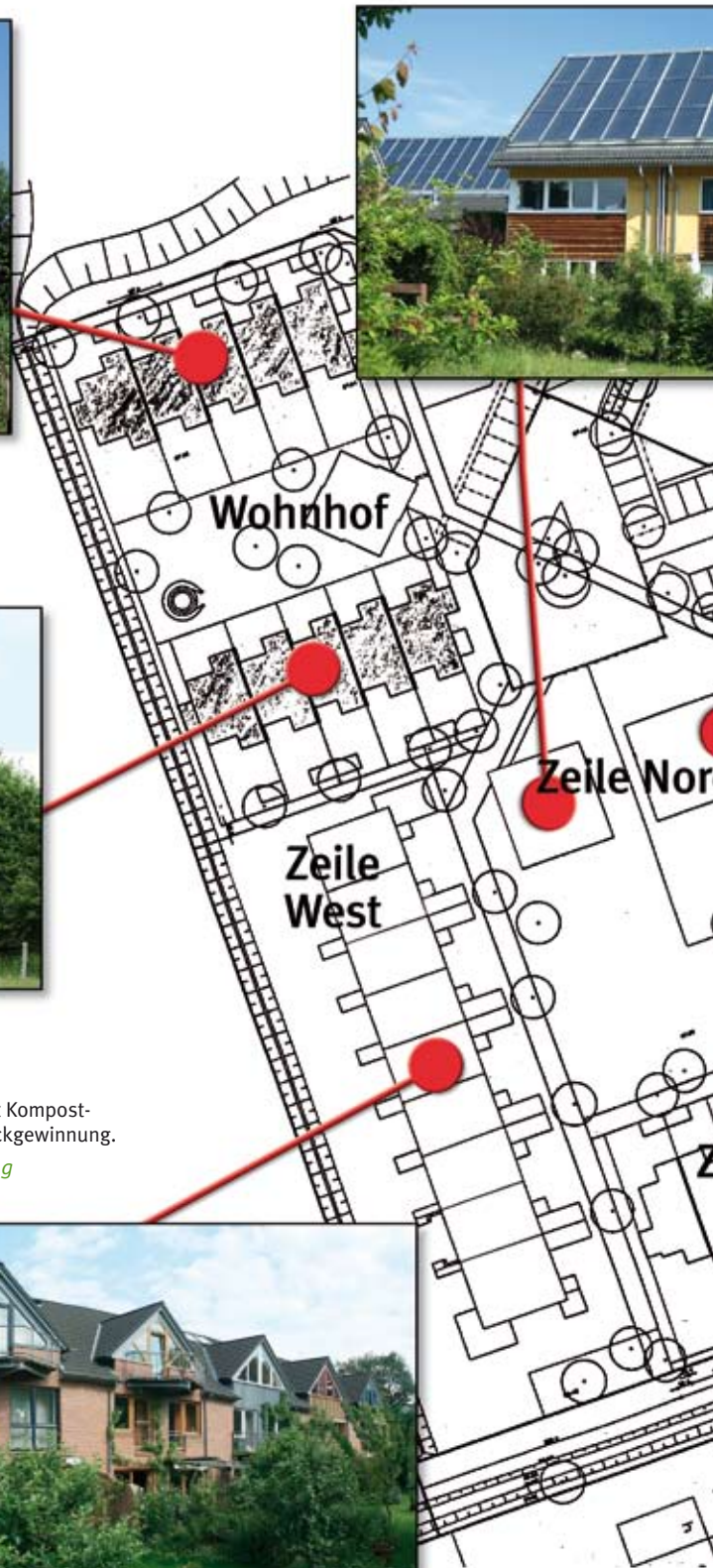
Wohnhof: zwei Reihenhauszeilen in Holzständerbauweise mit Kompost-toiletten, Lüftung ohne Wärmerückgewinnung und 50 m 2 Fotovoltaikmodulen.
